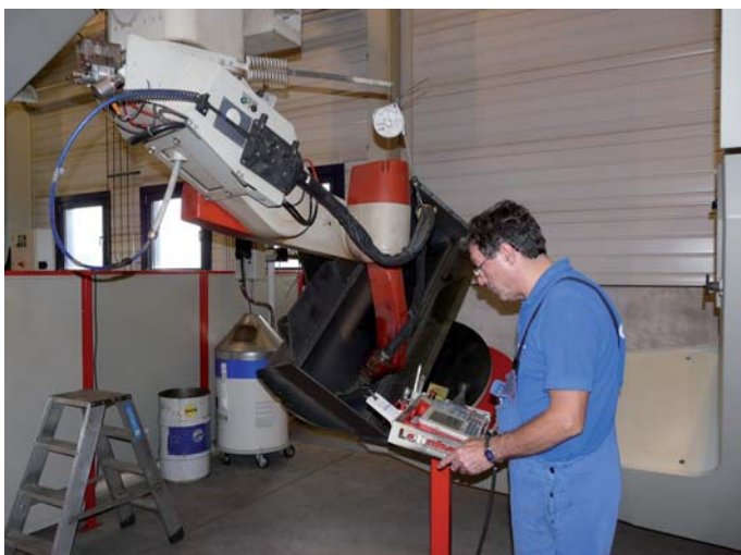
Robotergestützte Löffelfertigung: Die Rechnersteuerung mit modernster 3D-Software erlaubt die Anwendung des Teach-In-Verfahrens ebenso wie die Offline-Programmier-Technologie beim Schweißroboter. Bei Letzterer wird in einer virtuellen Umgebung am Rechner dreidimensional im Raum programmiert.
