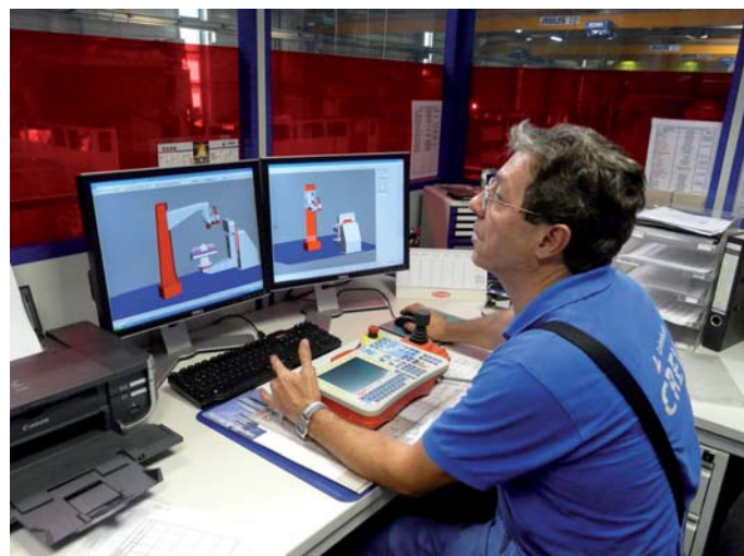
Robotergestützte Löffelfertigung: Die Rechnersteuerung mit modernster 3D-Software erlaubt die Anwendung des Teach-In-Verfahrens ebenso wie die Offline-Programmier-Technologie beim Schweißroboter. Bei Letzterer wird in einer virtuellen Umgebung am Rechner dreidimensional im Raum programmiert.
