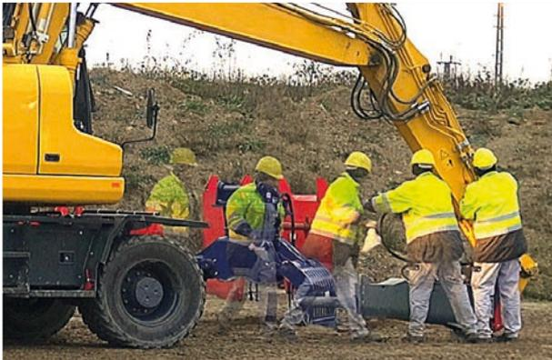
Das war gestern: Bei nicht vollhydraulischen Systemen hält sich beim Werkzeug-Wechsel ständig eine Person im Gefahrenbereich auf.
