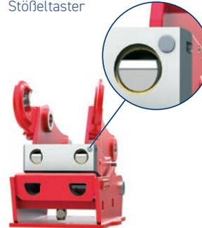
Automatisch geführt. Die Verriegelungsbolzen werden erst bei Kontakt des Stößeltasters mit der Adapter-Riegelplatte ausgefahren.
